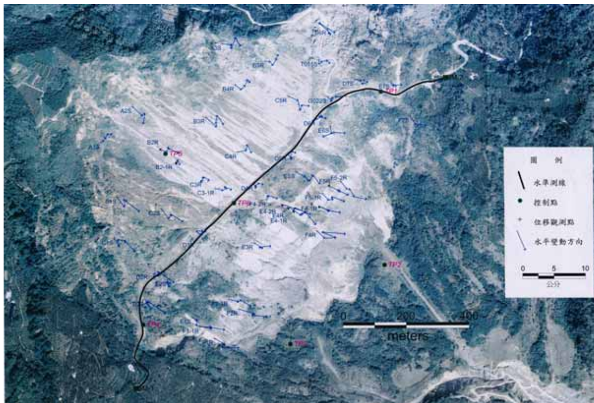
圖 15 崩塌區水平位移向量圖
